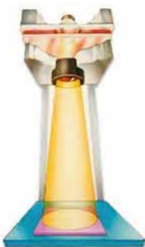
光源投射通过移动的油柱或燃料柱，流体中的污染物阻断光束，投影至光电二极管元件，在其中引起光强度的变化从而产生与之直接成正比的电压输出变化。
